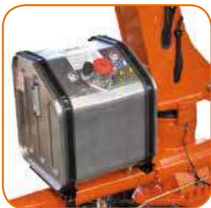
Ölbehälter Oil Tank
